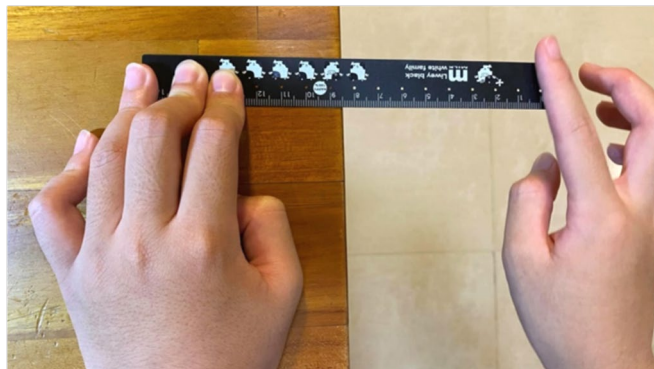
圖 5 用手壓彈凸出桌面邊緣的尺，尺彈回振動發出聲音
