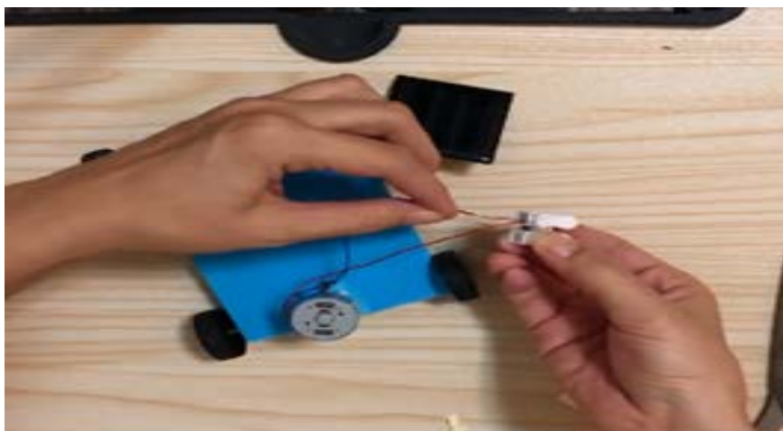
圖 11：將馬達與太陽能板的電線夾入連接器中(同色線相接)
