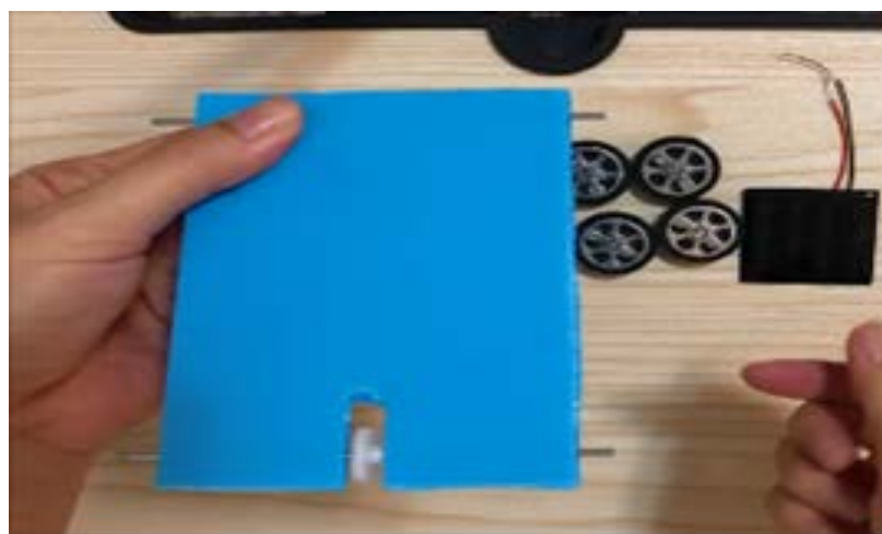
圖 5：轉動軸穿入瓦楞板內部空隙
