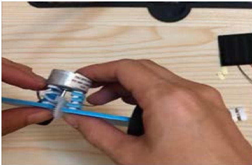
圖 10：.將馬達黏於小長方形堆頂部，並將小齒輪與大齒輪緊密接合
