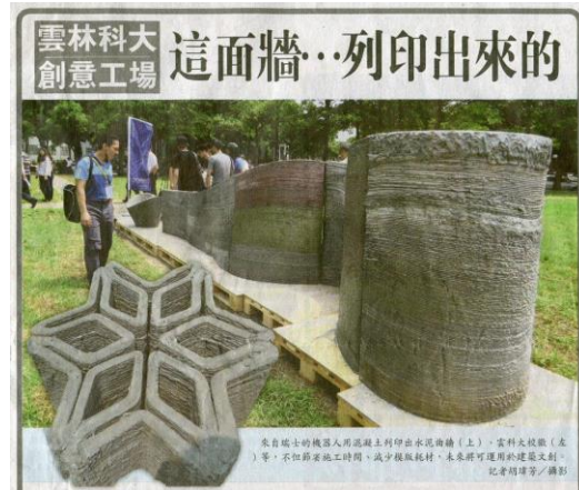
圖 7 機器人混凝土列印&指導老師|Florian Frank, Shih-Yuan Wang, Georg Breitenberger
